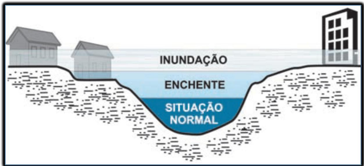
Figura 5 - Perfil Esquemático do Processo de Enchente e Inundação. Fonte: MINISTÉRIO DAS CIDADES /IPT 2009.
