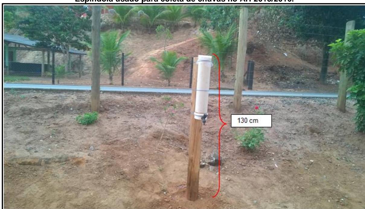
Figura 20 – Pluviômetro experimental 1 P1), a 87 metros de altitude, na Rodovia Josil Espíndola usado para coleta de chuvas no AH 2015/2016.
