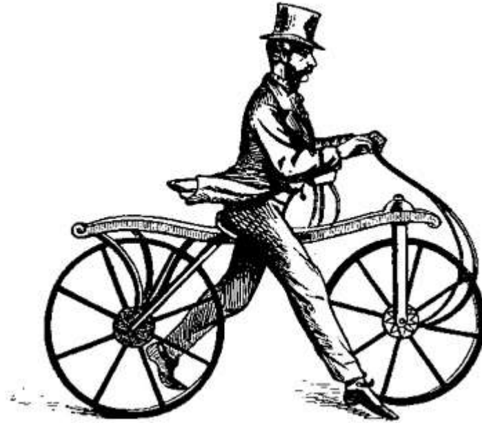
Figura 5 – “Draisienne” – sendo movimentada
