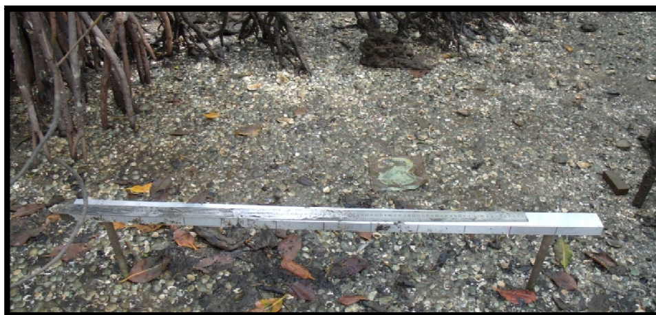
Figura 4.8. Imagem mostrando as barras e a escala posicionada para as medições e a presença de conchas marinhas sobre o sedimento no ponto 7. Foto: Gabriela C. Zamprogno.
