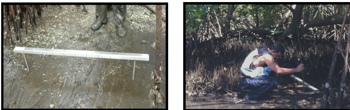
Figura 4.1. Metodologia de monitoramento da morfologia superficial da planície de maré, com destaque para as barras introduzidas no sedimento e escala para medição da distância entre o topo das barras e a superfície do sedimento.
