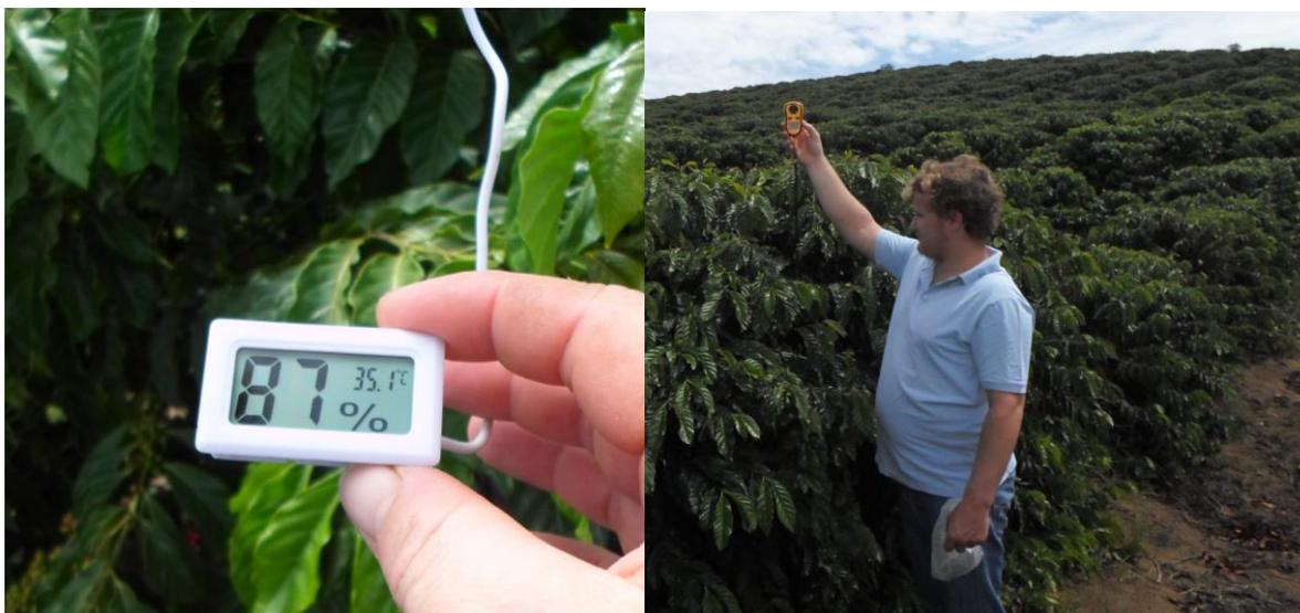
Figura 2. Medições da umidade relativa do ar, temperatura ambiente e velocidade do vento.
