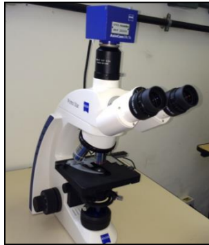
Figura 10 - Fotomicroscópio óptico Primo Star Zeiss com câmera acoplada AxioCam ERc5s. FONTE: Dados da pesquisa. PPGCO/UFES, 2015.
