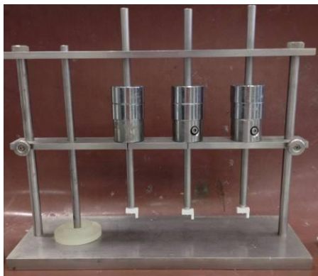
Figura 14 - Pesos acoplados no equipamento de hastes verticais móveis do Laboratório de Biomateriais e Biologia Oral da FO-USP.
