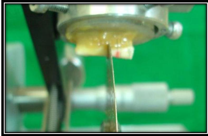
Figura 11 - Dente sendo cortado na máquina Labcut 1010.
