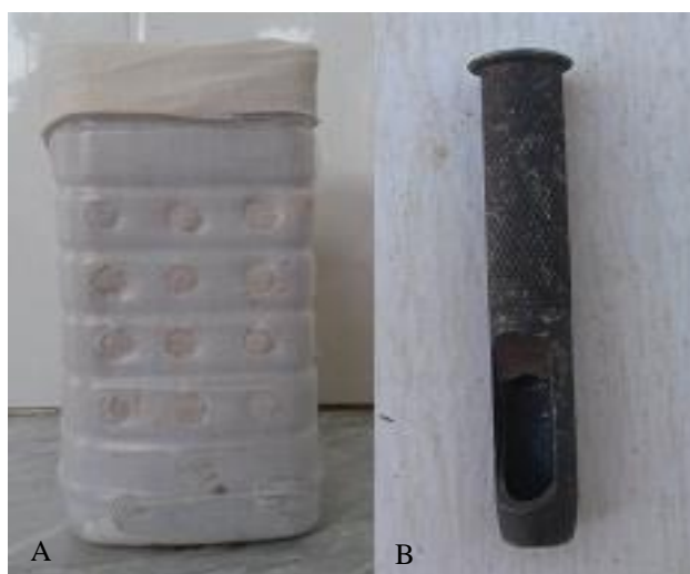
Figura 2: (A) pote padronizado com furos de 25mm e revestido com uma malha de pano; (B) vazador de aço de 25mm.
