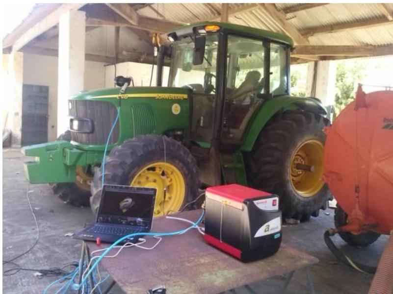
Os gases foram captados no duto do escapamento do veículo por meio de uma sonda, passando por um processo de separação da água mais particulados por meio dos filtros e em seguida dirigidos ao banco de medição. Um feixe de luz de raios infravermelhos, gerados por um transmissor é enviado através dos filtros óticos para os elementos de medição.
