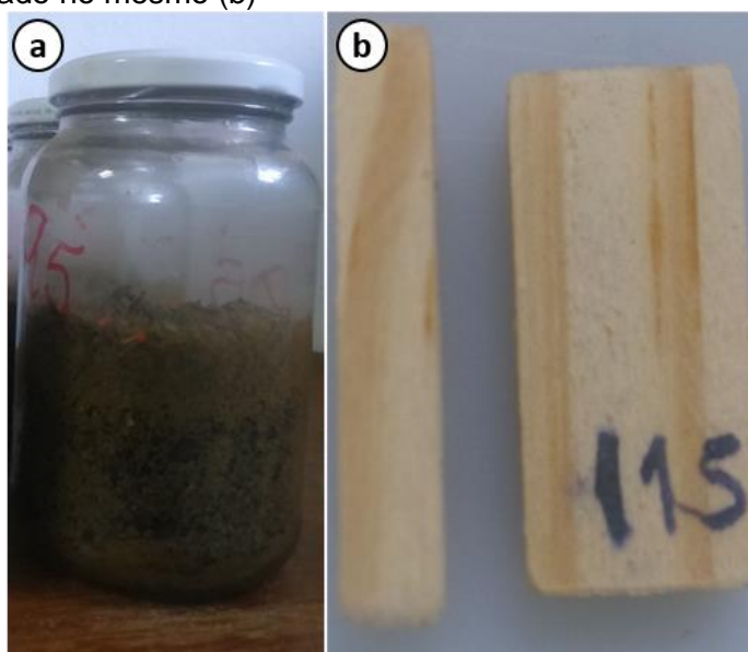
Figura 8 - Frasco com solo para ensaio de podridão mole (a) e corpo de prova a ser soterrado no mesmo (b)
