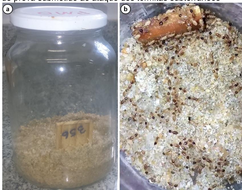
Figura 5 - Ensaio de alimentação forçada, (a) frasco com corpo de prova e (b) corpo de prova submetido ao ataque dos térmitas subterrâneos
