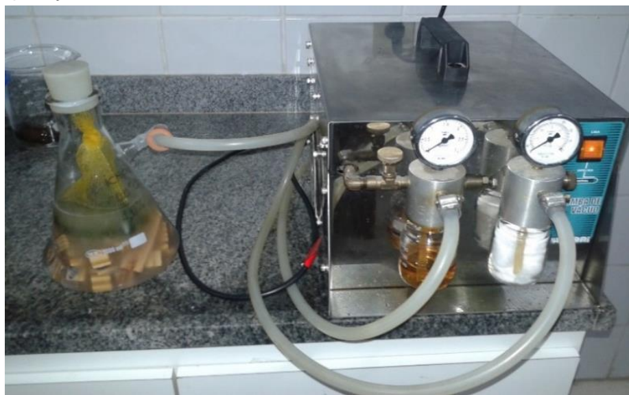
Figura 4 - Impregnação da madeira com solução aquosa de biossílica por imersão e aplicação de vácuo
