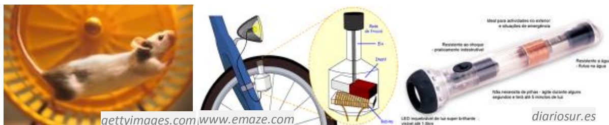
Figura 40. Eis algumas sugestões: posso colocar um rato para girar uma gaiola e acoplar esta gaiola ao ímã; ou então, posso transferir o movimento de giro da roda da bicicleta para girar esta ímã; ou ainda, posso criar uma lanterna com uma bobina fixa e um ímã móvel, assim, quando eu agitá-la, vai haver movimento relativo, gerando Energia elétrica também!
