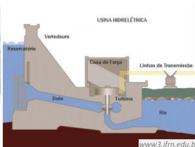
Figura 26. Foto real de uma usina hidroelétrica: uma enorme quantidade de água armazenada na represa pela barragem de concreto (tudo o que existia ali foi retirado ou alagado); no esquema de funcionamento da usina, repare que a água que faz girar o gerador sai da parte inferior da represa (onde há maior pressão), portanto, a água de vemos escapar pela parte de cima (como visto na foto) é o excedente, ou seja, o que o gerador não utiliza, mas é necessário para dar a vazão ao rio.
