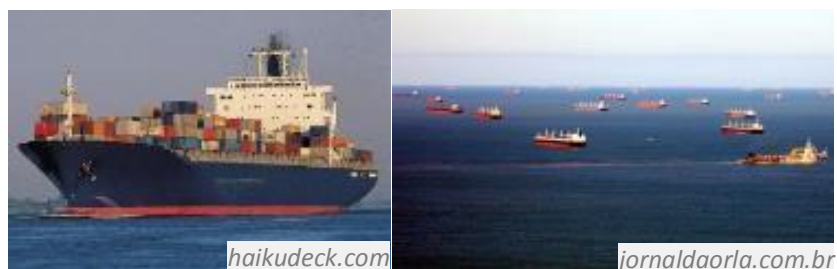
Figura 46. Um grande navio de transportar container (como o da figura da esquerda), tem motores que ultrapassam facilmente os 50MW. Só nesta figura da direita teríamos dezenas de milhões de W. Agora, e no mundo inteiro, com milhares desses.
