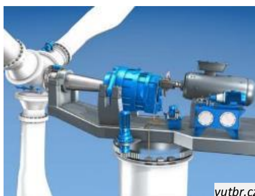
Figura 31. Esquema de funcionamento da usina eólica: o movimento das pás comunica Energia cinética ao gerador. A caixa azul neste esquema representa a caixa que faz, através de engrenagens, aumentar a rotação do eixo, pois as pás giram muito lentamente.
