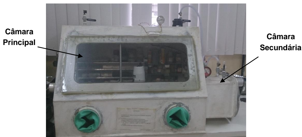
Figura 3.1: Caixa de Luvas utilizada para a síntese e obtenção das Nanopartículas de \text{Fe}/\text{Fe}_2\text{B} .
