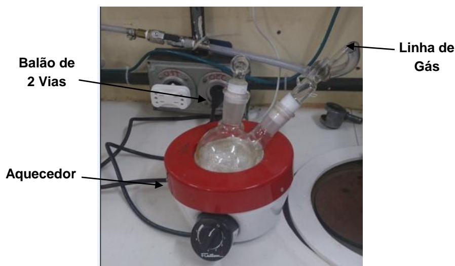
Figura 3.2: Processo de secagem a vácuo das nanopartículas de Fe/Fe_2B produzidas por Redução Química.
