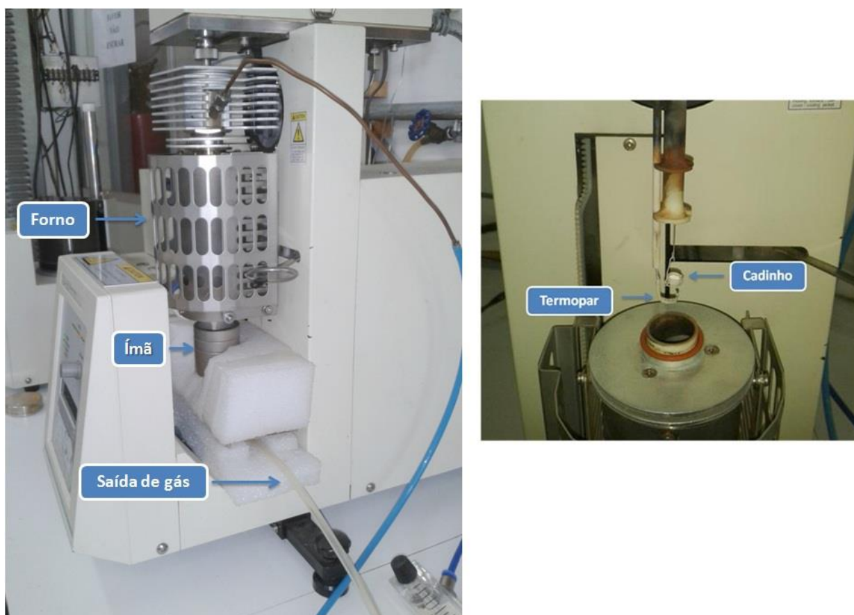
Figura 3.7 – Fotografia do TG-A e o aparato montado para realizar as medidas para obter a temperatura crítica. Na figura da esquerda é mostrado o ímã, que é colocado embaixo da balança onde está a amostra, o forno, e a mangueira para saída de gás. Na figura da direita é possível visualizar o cadinho em que a amostra é colocada e o termopar.
