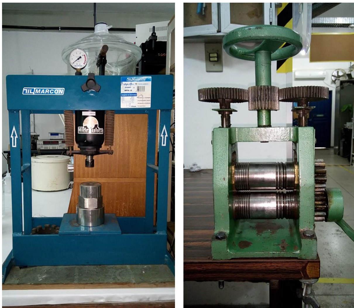
Figura 3.2 – Imagem da prensa hidráulica (à esquerda) e da calandra (à direita).
