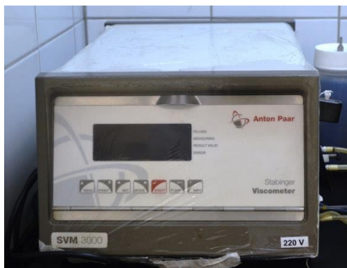
Figura 9. Viscosímetro Stabinger SVM 3000 fabricado pela Anton Paar. Fonte: Laboratório de Caracterização e Processamento Primário – UFES.
