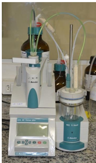
Figura 8. Titulador Karl Fischer Metrohm (modelo 870 KF titrimo plus). Fonte: Laboratório de Caracterização e Processamento Primário – UFES.
