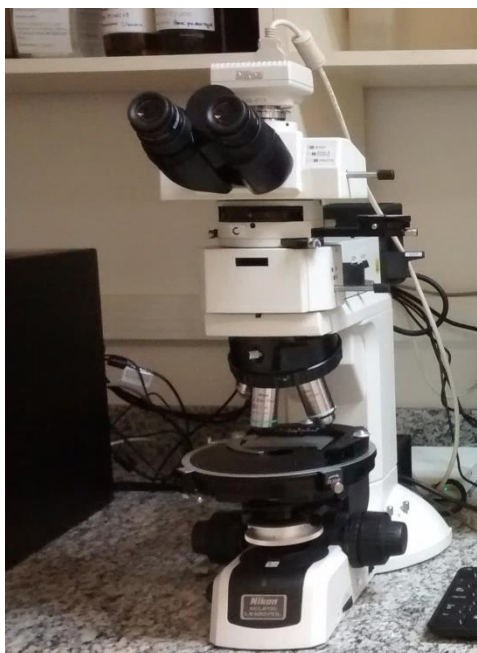
Figura 11. Microscópio Ótico Nikon modelo Eclipse LV100POL. Fonte: Laboratório de Caracterização e Processamento Primário – UFES.
