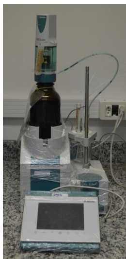
Figura 10. Titulador automático, modelo 905 Titrand, fabricado pela Metrohm. Fonte: Laboratório de Caracterização e Processamento Primário – UFES.
