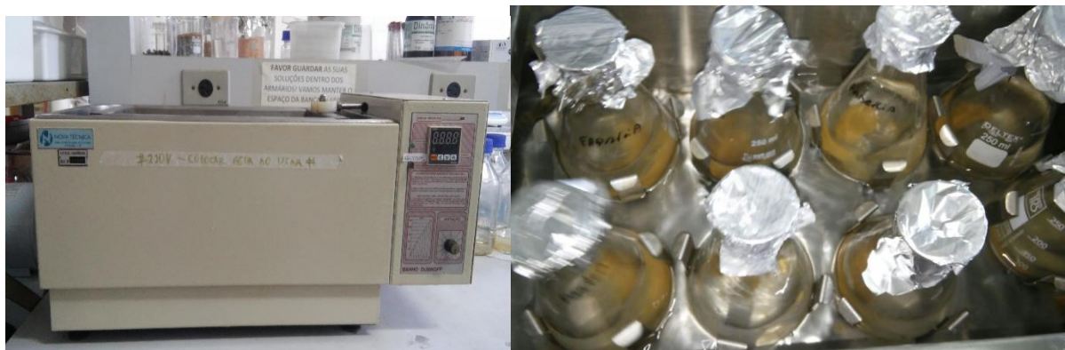
Figura 13. Shake de agitação. Vista externa (a esquerda) e vista interna (a direita).
