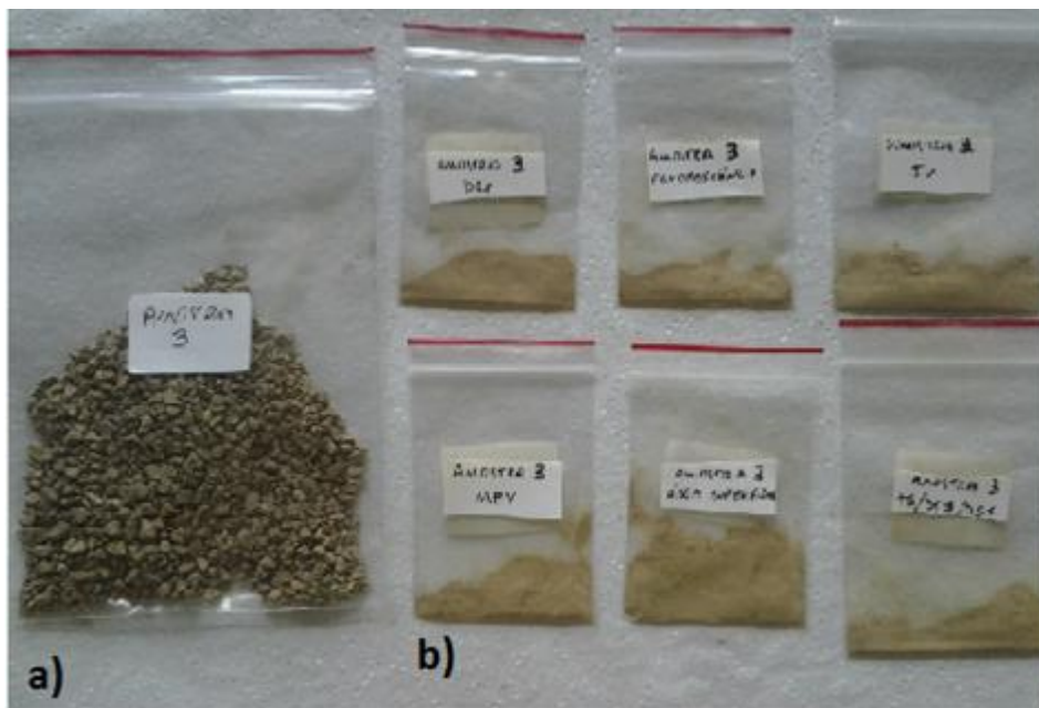
Figura 17. Argila organofilizada obtida no preparo. (a) Amostra após filtração e secagem. (b) Amostras preparadas para a caracterização, após maceramento e classificação em peneira menor de 200 mesh.
