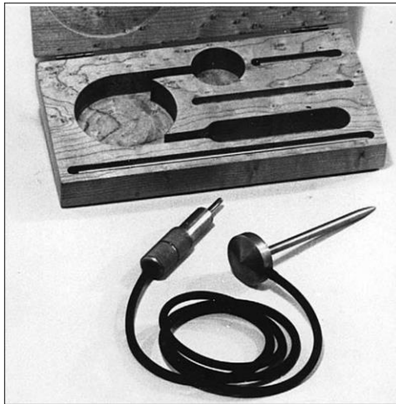
Figura 2 – Acelerômetro B&K modelo 4303, provavelmente o primeiro acelerômetro piezoelétrico disponível comercialmente.
