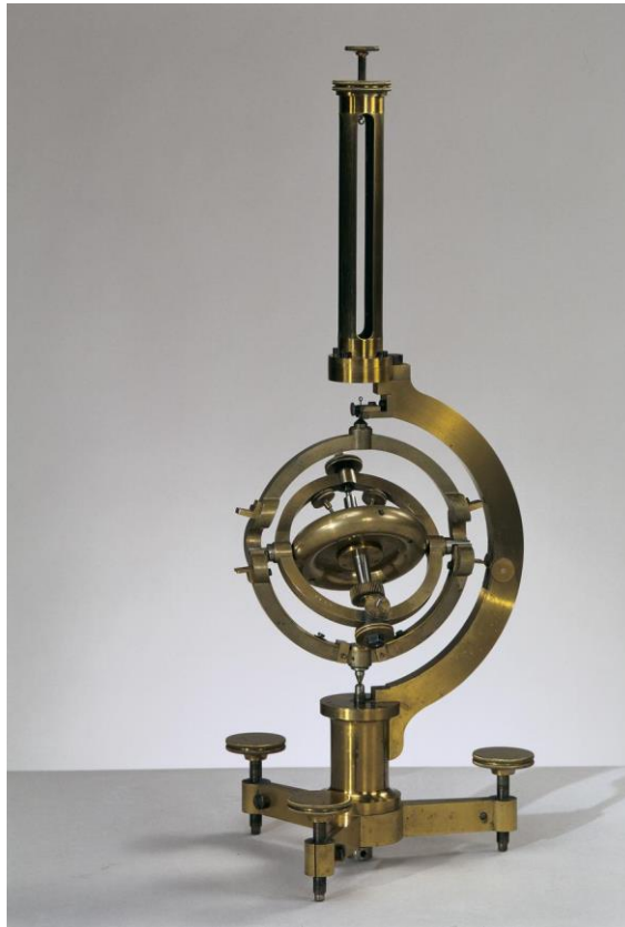
Figura 3 - Giroscópio projetado por Léon Foucault e construído por Pierre Dumoulin-Froment em 1852. Se encontra no museu de artes e ofícios de Paris.
