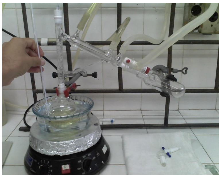
Figura 3.3 Foto do Sistema de destilação do ligante sob atmosfera inerte e pressão reduzida
