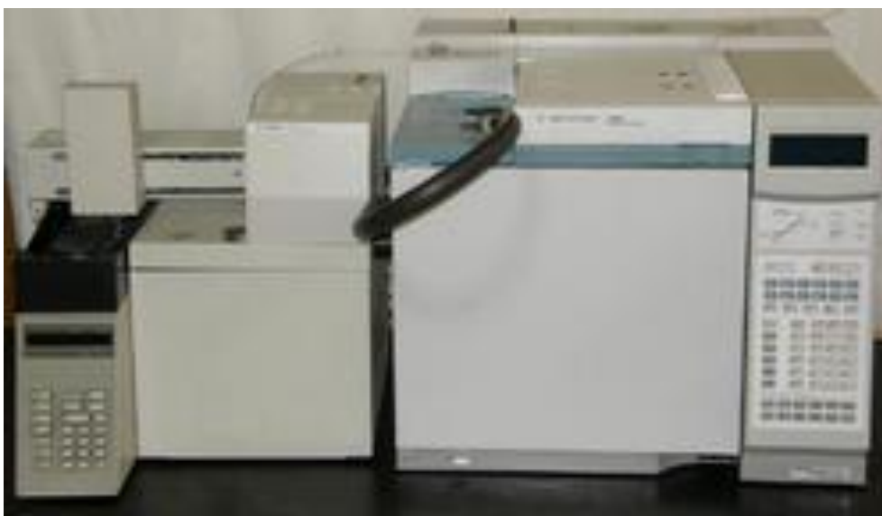
Figura 3.13 Cromatógrafo à gás acoplado à um espectrômetro de massas com um acessório Headspace.
