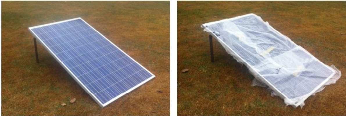
Figura 47: Testes de Variação Insolação. (a) Insolação Natural (b) Insolação Reduzida
