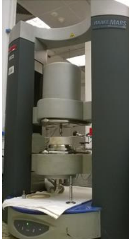
Figura 21 – Reômetro de cilindros concêntricos HAAKE MARS II utilizado para determinação das viscosidades das emulsões de petróleo.
