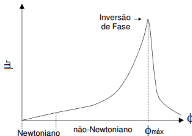
Figura 15 – Comportamento reológico de dispersões em função do teor da fase dispersa. Fonte: Karcher (2008).
