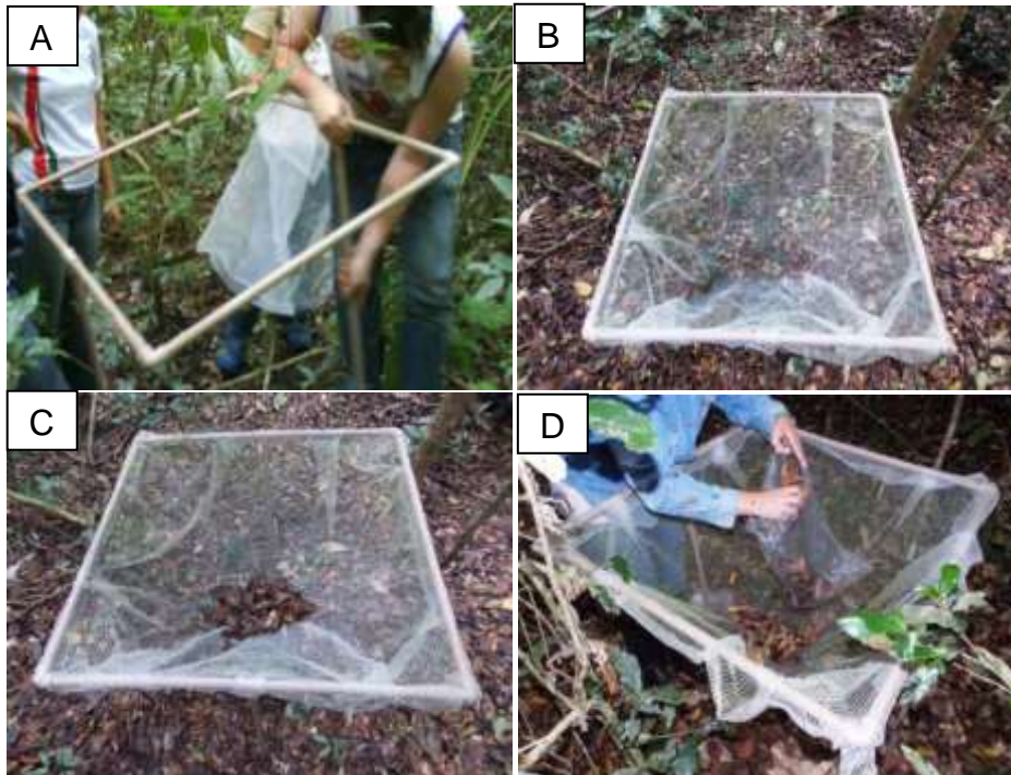
Figura 2.1- Coletor de serapilheira depositada confeccionado em estrutura de pvc com tela de nylon. (A) montagem do coletor; (B) imagem superior, (C) amostra de serapilheira depositada e (D) coleta de serapilheira depositada.
