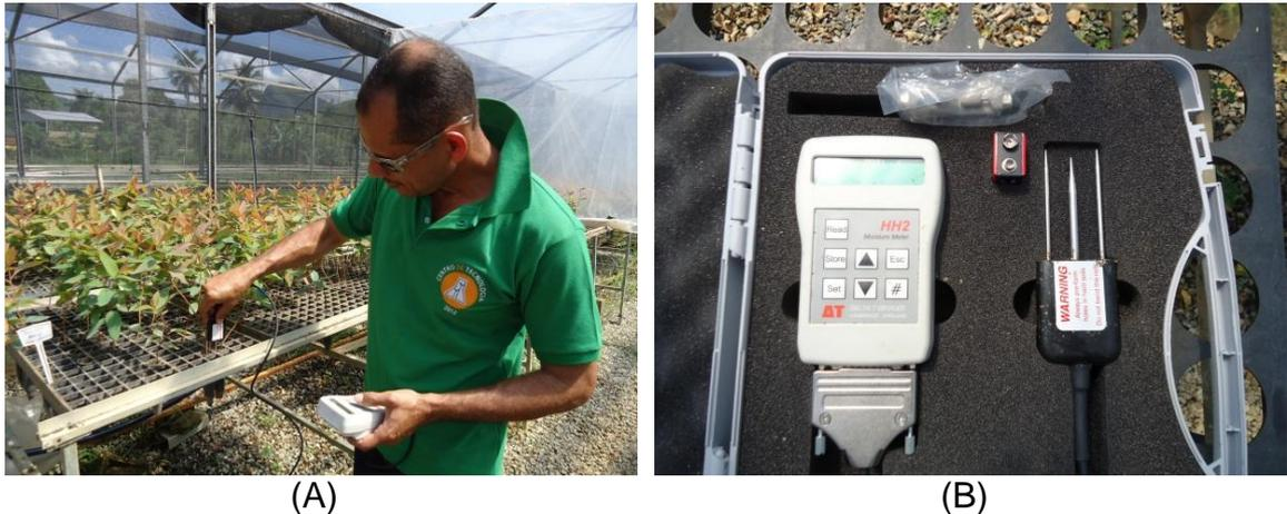
Figura 6. (A) Ilustração da realização da medição do teor de água no substrato por meio de leitura direta com o sensor WET-2 e (B) Aparelho WET-2.
