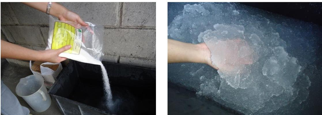
Figura 14. Hidratação do polímero hidrorretentor, (A) Adição de 330 g do hidrorretentor a 30L de água e (B) Hidrorretentor hidratado após 30 minutos.
