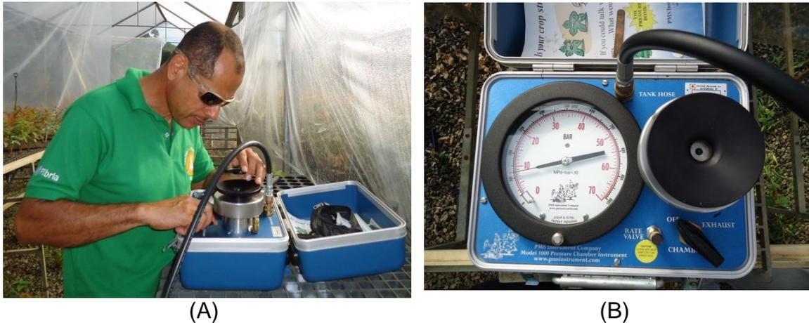
Figura 7. (A) Ilustração da realização da leitura do potencial hídrico foliar pelo técnico da Fibria S. A. e (B) Equipamento utilizado para medição do potencial hídrico, câmara de pressão.
