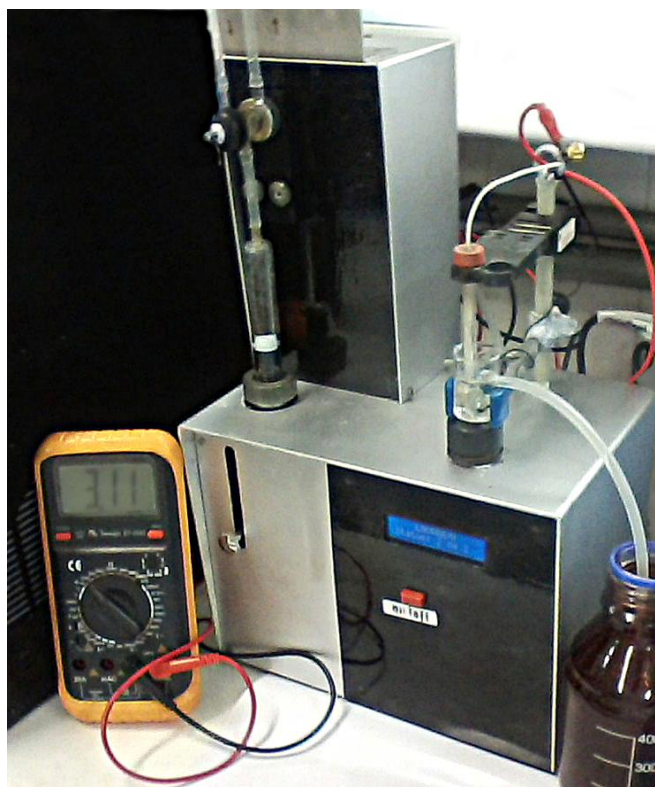
Figura 25. Segundo aparato construído para limpeza e ativação do eletrodo DDB.
