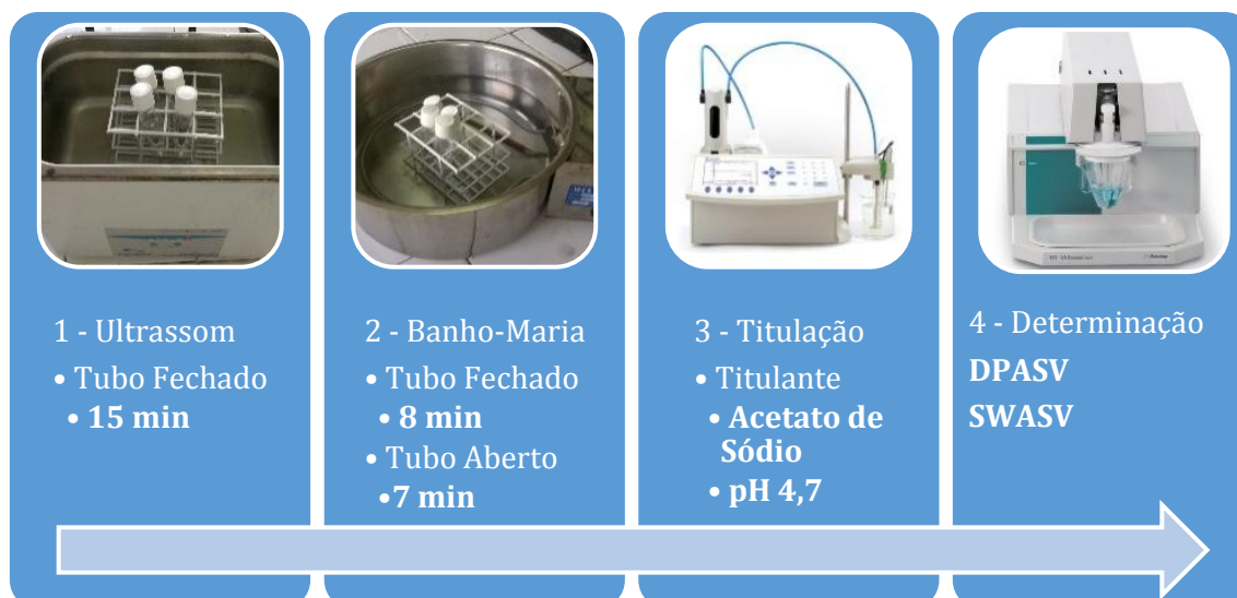
Figura 38. Esquema da digestão da água de coco assistida por ultrassom para análises voltamétricas.
