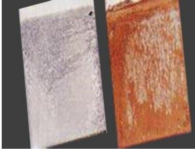
Figura 1: Diferença entre chapas sem corrosão e com corrosão uniforme. 11
