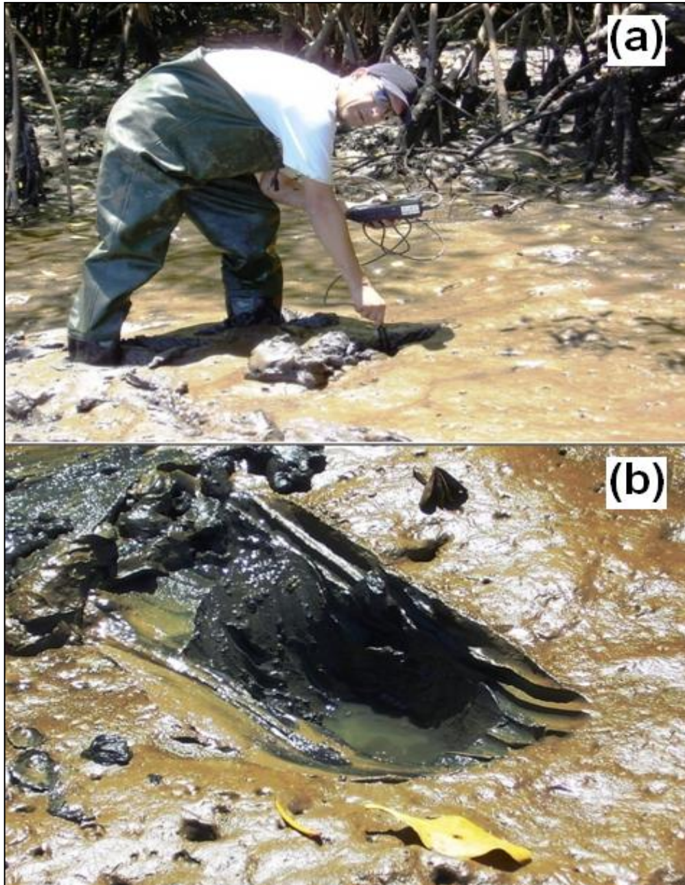
Figura 14 – a) medidas in loco dos parâmetros físico-químicos ORP, temperatura e pH; b) medida de OD na água intersticial drenada onde foram efetuadas as medidas de OD.
