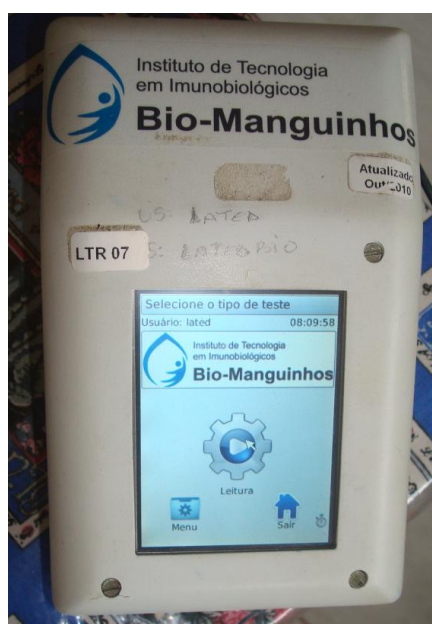
Figura 5. Leitor óptico da Bio-Manguinhos que mede a reflectância da reação em unidades relativas de luz.
