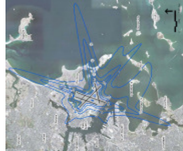
Figura 55 - Mapa Acústico - Estados Unidos. Mapa da cidade de Boston, contorno do Aeroporto Logan.
