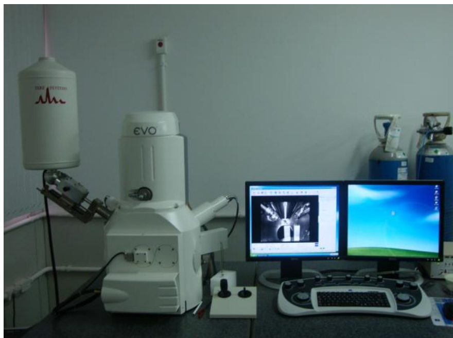
Figura 4.9: Microscópio eletrônico de varredura do Laboratório de Análise de Superfície de Materiais (LCSM) do Departamento de Engenharia Mecânica, no Centro Tecnológico da Universidade Federal do Espírito Santo.
