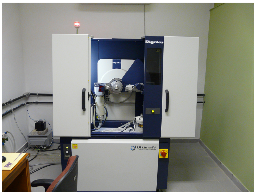
Figura 4.5: Difratômetro de raios X pertencente ao centro tecnológico da Universidade Federal do Espírito Santo.
