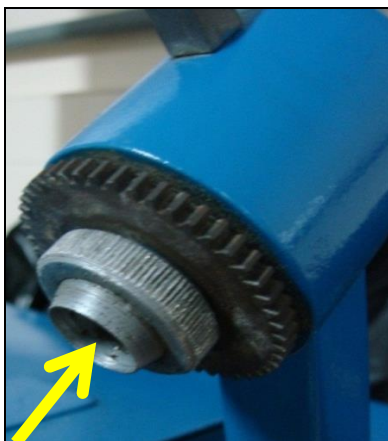
Figura 32: Orifício aonde a amostra será colocada. Fonte: Pelo próprio autor, 2012.
