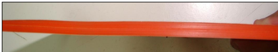
Figura 25: Irregularidades geométricas do material PU. Fonte: Pelo próprio autor, 2012.
