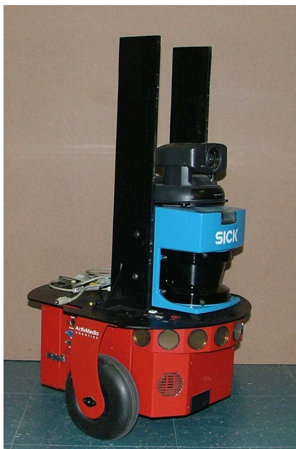
Figura 56: Robô móvel a rodas PIONEER 2-DX.
