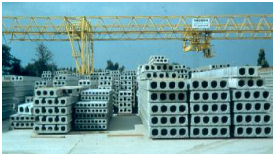
Figura 43 – Armazenamento de elementos pré-fabricados em concreto. Fonte: FEBE (2009)
