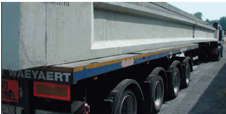
Figura 44 – Caminhão transportando elemento de concreto pré-fabricado de grande dimensão. Fonte: FEBE (2006)
