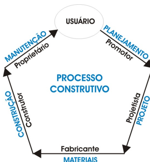
Figura 25 – Processo construtivo e suas fases Fonte: Adaptado MESEGUER (1991)
