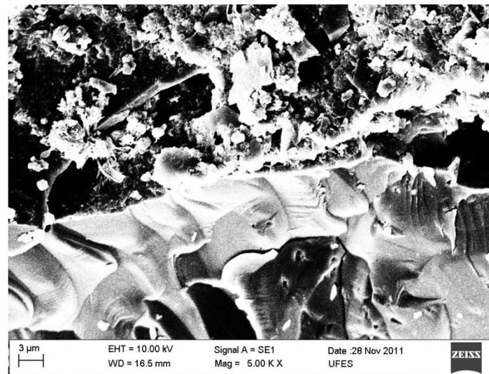
**B.7 Micrografias e análises químicas por EDS dos concretos com substituição do CAP I**
