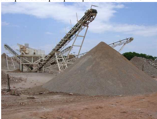
Figura 65 - Peneira vibratória e correias transportadoras para produção de ARC na SP 3
