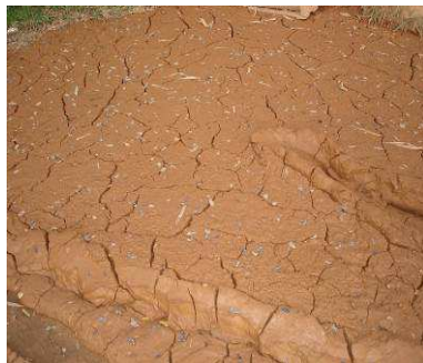
Figura 88 - Resíduo cerâmico originado na lavagem de areia reciclada
