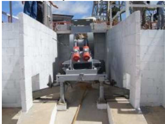
Figura 5 - Central de reciclagem móvel utilizada para reciclagem em canteiro de obra
