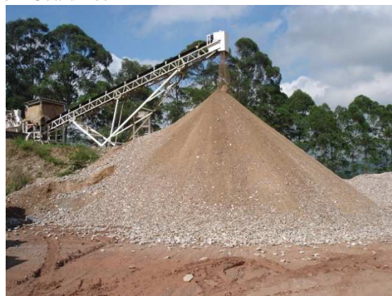
Figura 66 - Produção de bica corrida na usina SP 4, em Guarulhos
