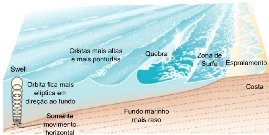
Figura 5: Empinamento e quebra da onda devido a influencia do fundo marinho. Fonte: Coleman (2001), adaptado aqui.
