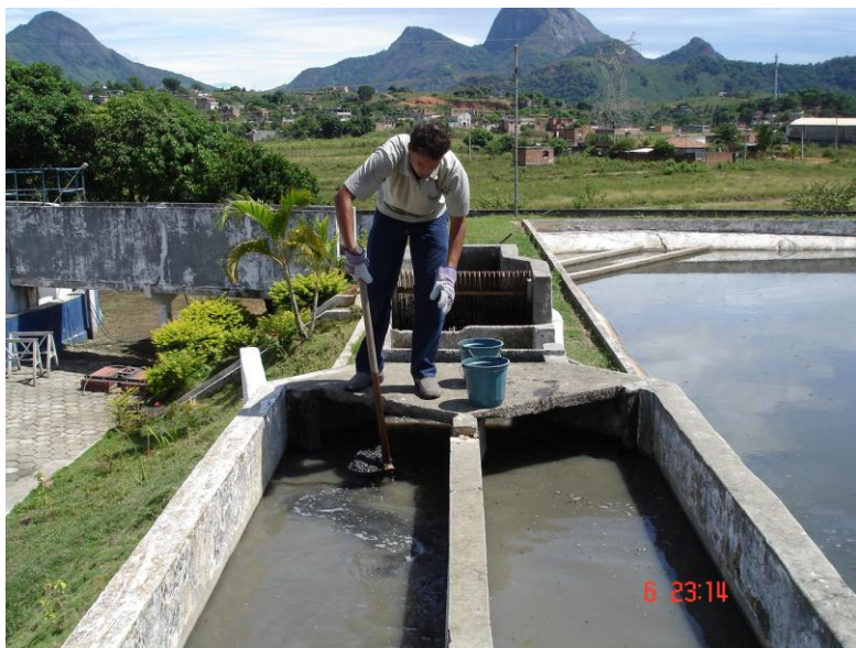
Figura 4.2 – Coleta de amostra na caixa de areia da ETE Marcílio de Noronha
