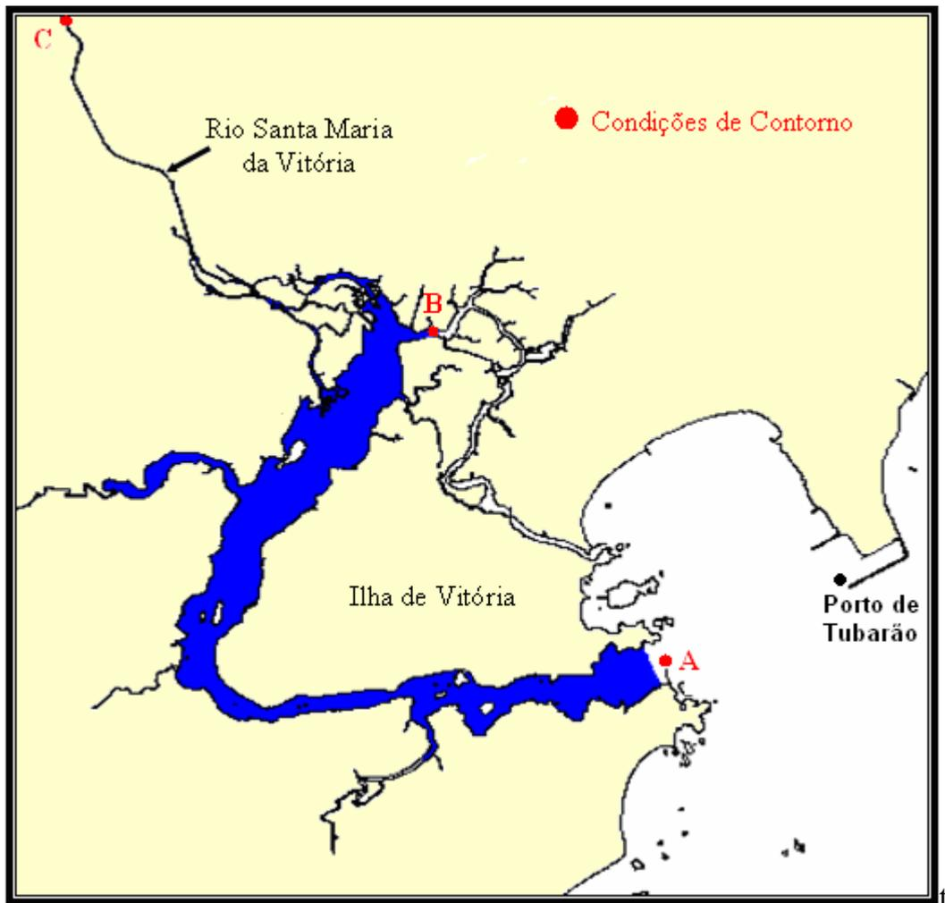
Figura 8: Condições de Contorno implementadas no modelo hidrodinâmico.
