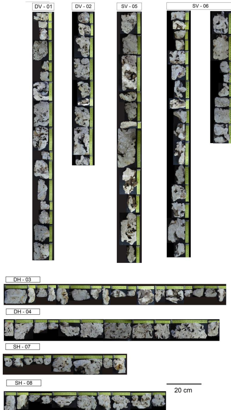
Figura 4: Fragmentos coletados a cada inserção de 50 centímetros do equipamento na estrutura recifal resultando nos testemunhos verticais DV-01, DV-02, SV-05 e SV-06 e nos
