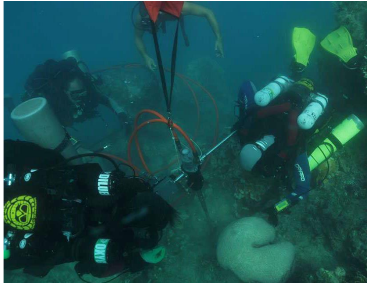
Figura 2: Perfuração a partir de Drill Hidráulico.
