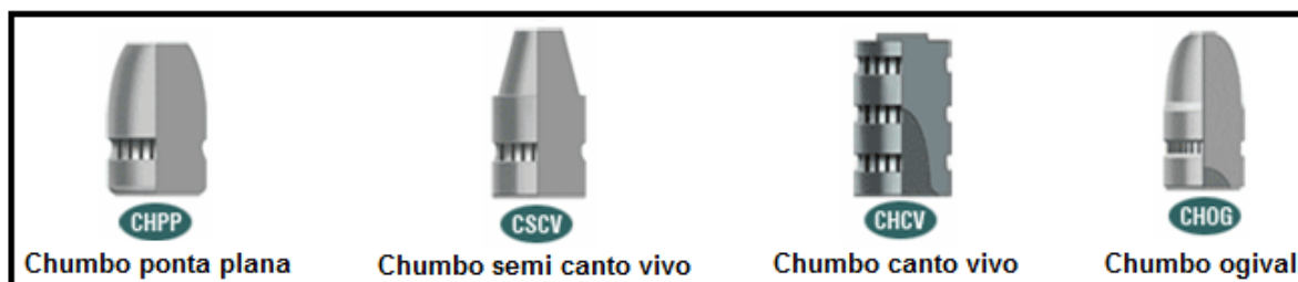
Figura 12. Modelos de projéteis de chumbo – Adaptada 65
