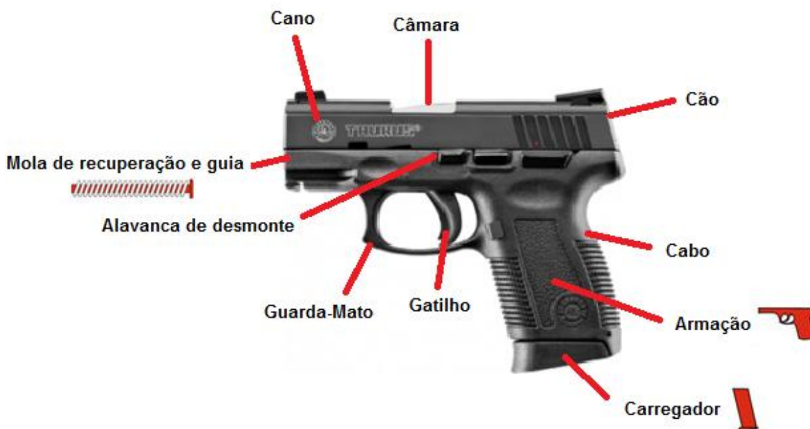
Figura 22. Principais partes que compõe uma pistola – Adaptada 65
