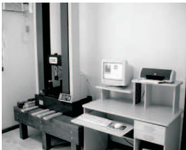
**Figura 1** – Máquina universal de ensaios com tomada automática de dados.
