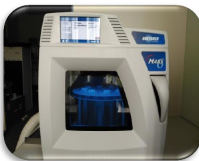
Figura 5: Equipo utilizado para la extracción asistida por microondas (MAE)
