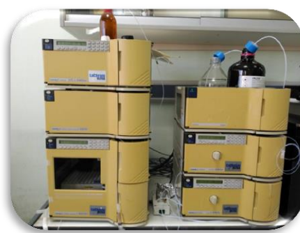
Figura 9: Equipo de cromatografía HPLC
