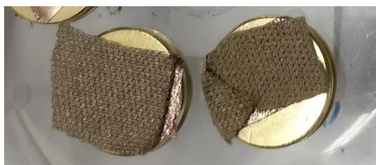
Figura 5. 13. Fragmento de telas de poliéster (impregnada y sin impregnar) cubiertas por una fina capa de oro como paso previo a su visualización al microscopio SEM.
