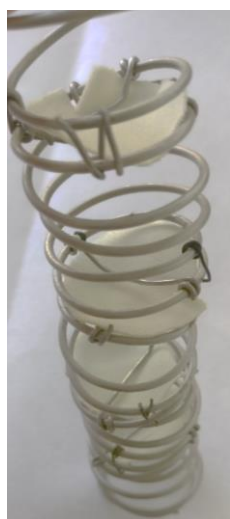
Figura 5. 2. Disposición de las telas sobre el reactor.
