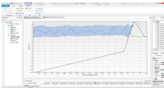
Figura 5. Pantalla principal del XBeach-G mostrando la estructura de la carpeta de entrada y salida (izq.), las características del oleaje en un momento concreto de la simulación (centro) y los parámetros de salida (dcha.).
