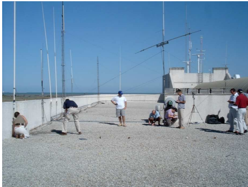
Campo de antenas. Preparación del instrumento medidor, selección de sondas, fijación de ángulos, de puntos y de distancias. Estación Universidad de Cádiz.
