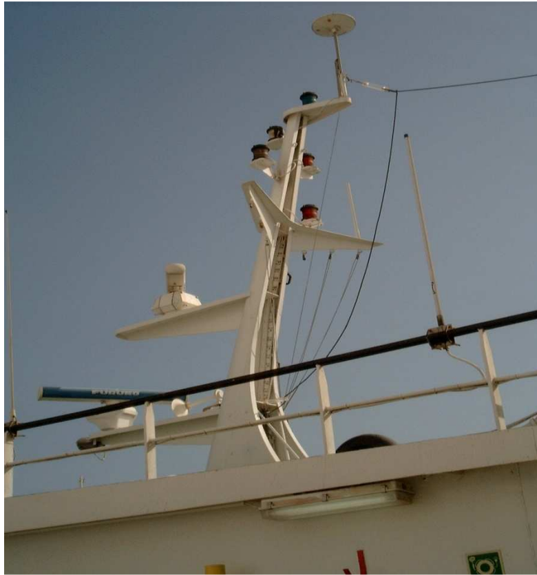
Antenas de los radares, de VHF y de Onda Media y Onda Corta.
