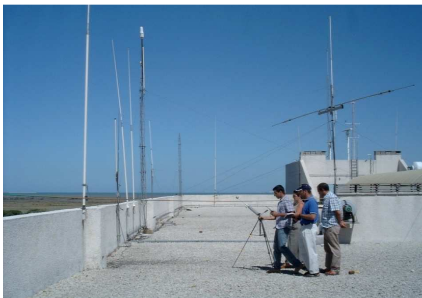
Campo de antenas. Preparación para mediciones simultáneas a varias antenas y comprobación de polarización angular-vertical de la sonda. Estación Universidad de Cádiz.
