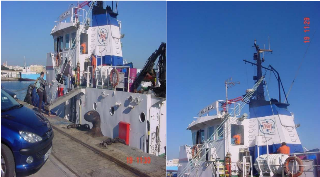
Remolcador Benicadell. Antenas de Onda Media, VHF y Radar.
