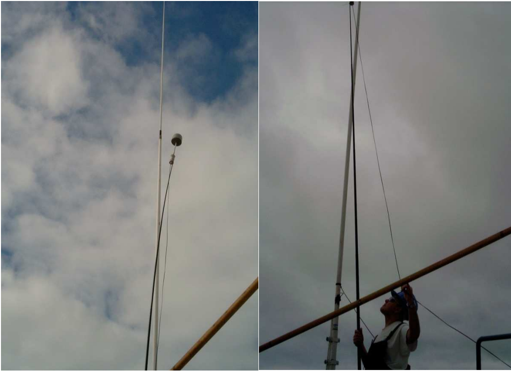
Buque de pesca Kukín. Posicionamiento de la sonda en la raíz de la antena para la realización de mediciones a varias alturas.
