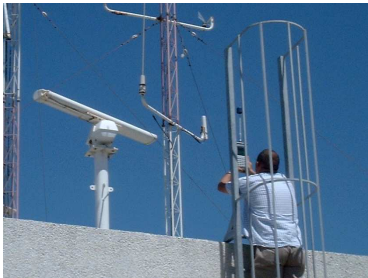
Campo de antenas. Realizando mediciones al Radar 2 en primeros puntos de distancias. Estación Universidad de Cádiz.
