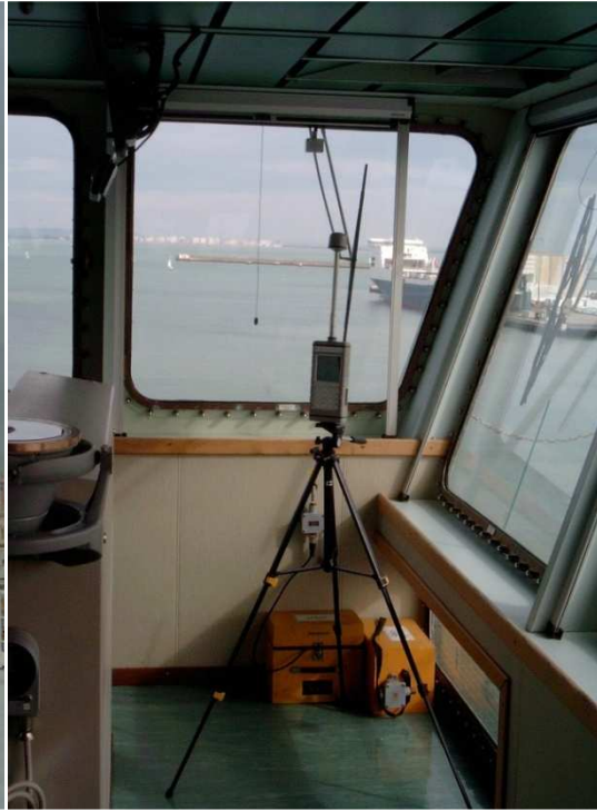
Mediciones en el interior del puente, bajo la cubierta del campo de antenas.
