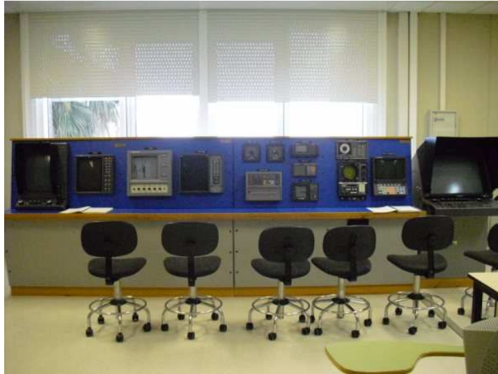
Consola de Instrumentos del Sistema Radioeléctrico de Ayuda a la Navegación. En los extremos los Equipos de Radiolocalización, Radar 2 y Radar 1. Estación Universidad de Cádiz.
