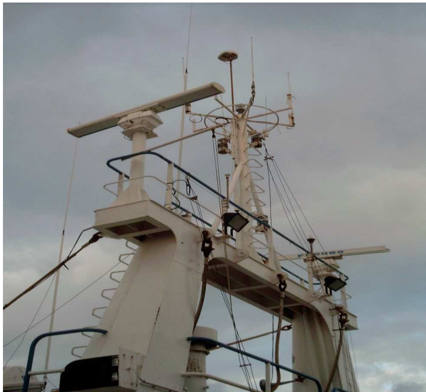
Buque de pesca Kukín. Detalle del campo de antenas. Disposición de antenas de radares sobre el pórtico y antenas de OM y de VHF.
