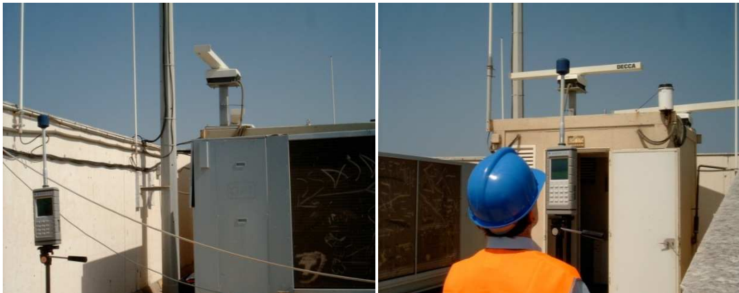
Centro de Salvamento Marítimo, Cádiz. Antenas del Radar 1 y del Radar 2. Posicionamientos de la sonda en diferentes distancias y a distintas alturas, líneas de orientación y puntos, para realizar medidas en Campo No Perturbado.
