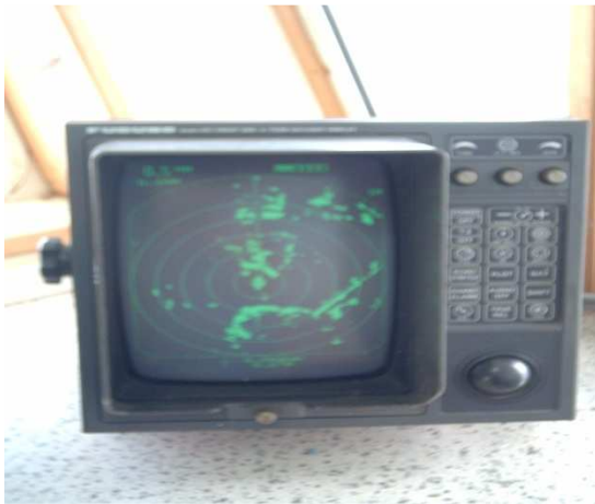
Unidad de presentación receptor Radar 1.
