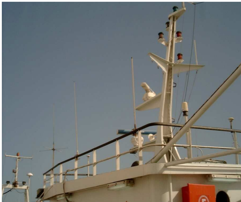
Antenas de los radares, de VHF y de Onda Media y Onda Corta.
