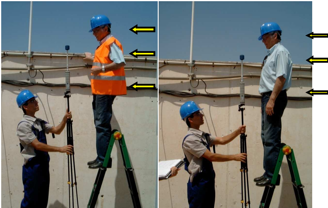
Centro de Salvamento Marítimo, Cádiz. Mediciones realizadas a la Antena del Radar 1, a varias alturas y distancias y en Campo Perturbado (las radiaciones del radar proceden de la parte derecha de la foto). En la la segunda fotografía se hacen las mediciones desprovisto de chaleco reflectante y de objetos metálicos.
