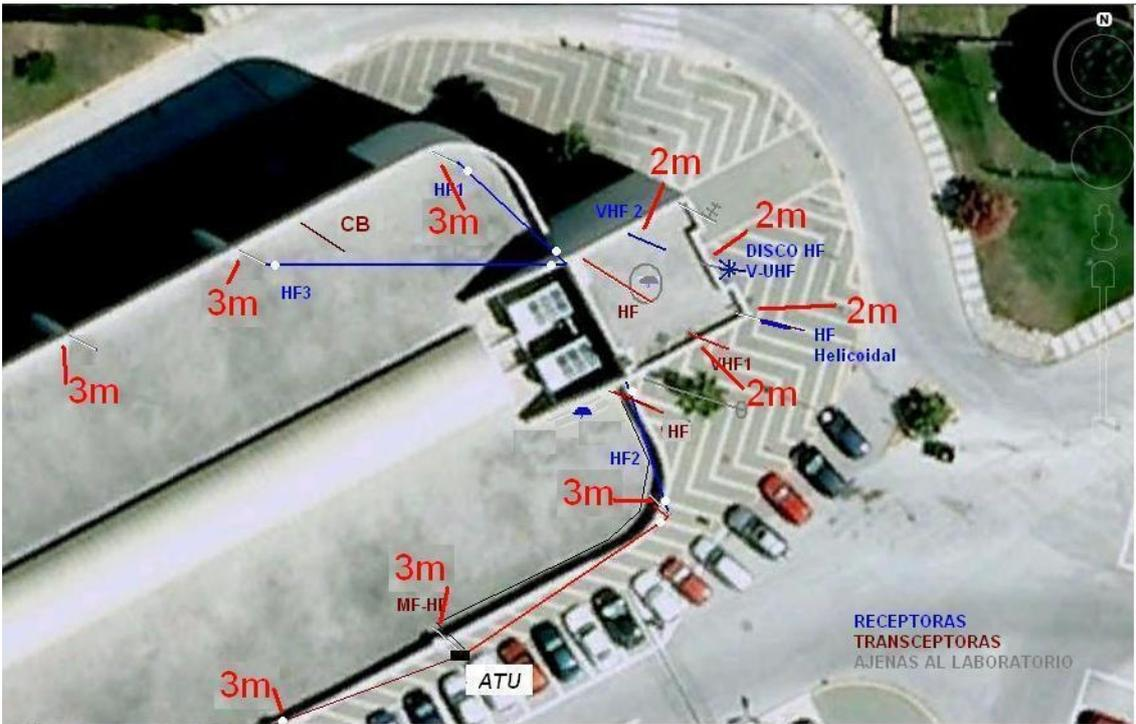
Figura 5.6.30 Detalle de distribución de antenas en el CASEM
