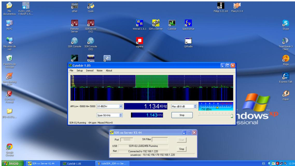
Figura 5.6.20 Cliente CuteSDR usando SDR-IQ a través de SDRxxServer
