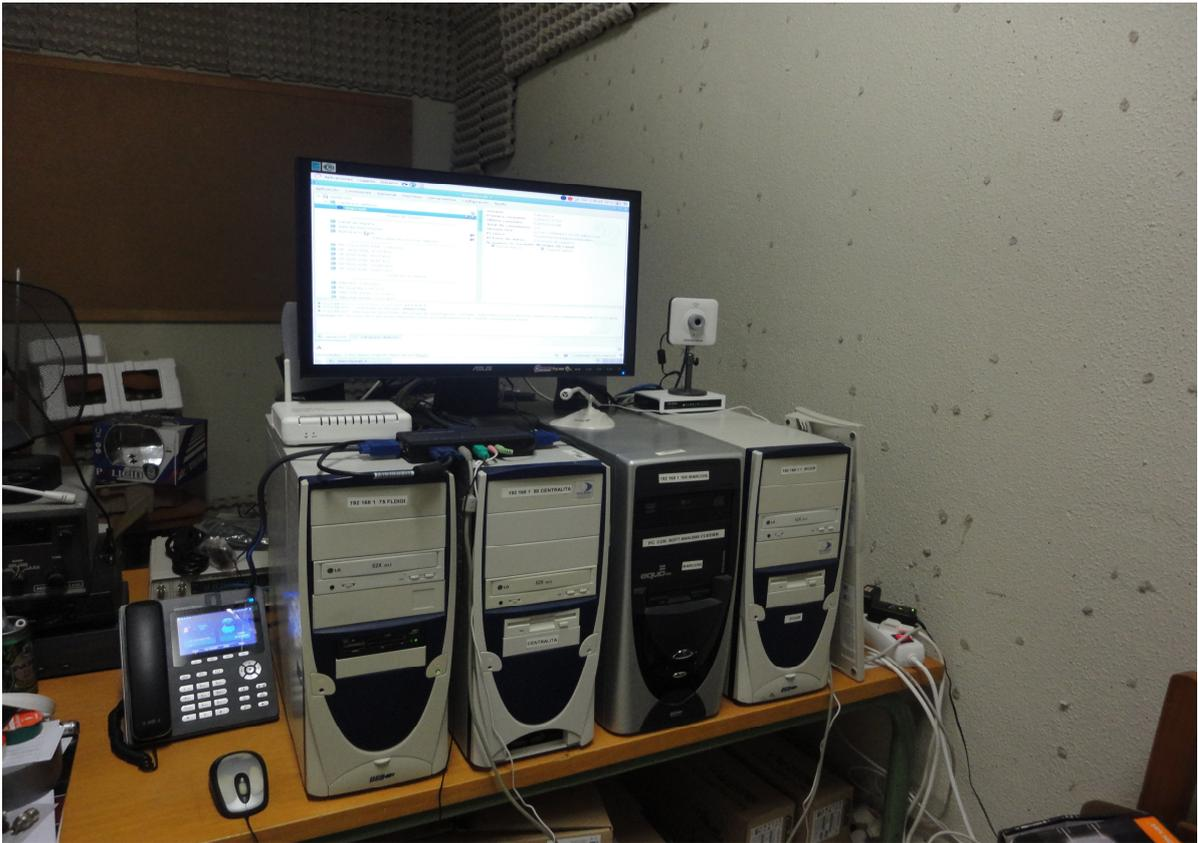
Figura 5.3.2 Servidores Teamspeak, Trixbox, IPCop, Fldigi/GNU-Radio y Cámara/Videoteléfono.
