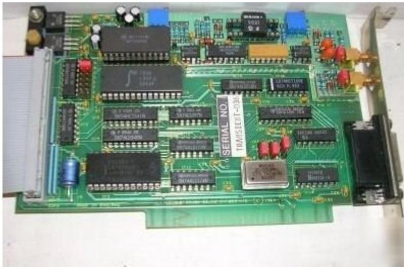
Figura 2.2.1 Tarjeta de aplicación programable Texas Instrument TMS320C30
