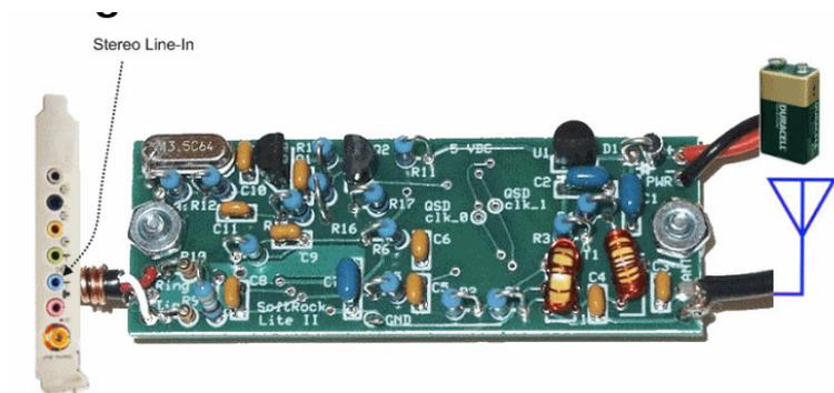
Figura 2.3.38 Conexiones externas. Softrock Lite II (FiveDashInc).
