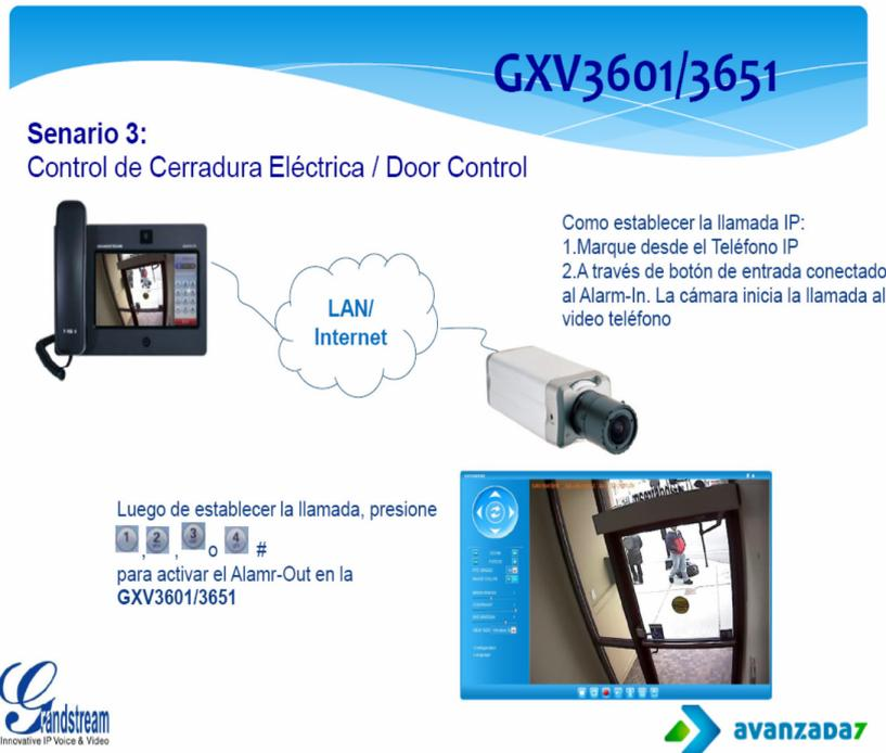
Figura 2.6.28 Configuración de teléfono Grandstream. Control de cerradura eléctrica. Ilustración cedida por Avanzada7.
