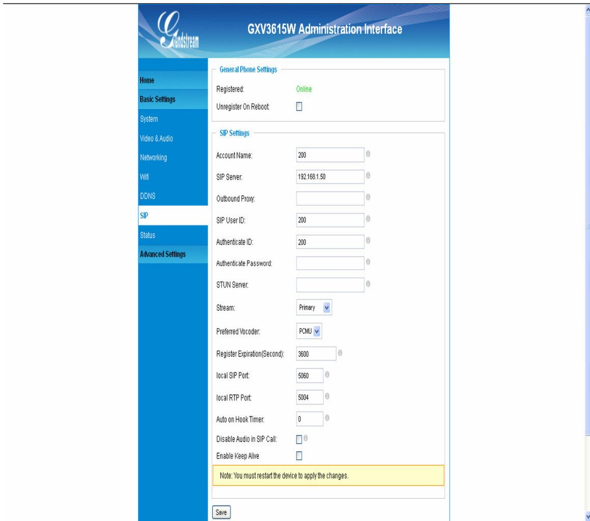
Figura 2.6.36 Cámara GXV3615W. Configuración básica SIP.
