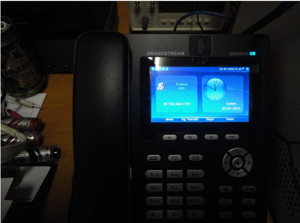
Figura 5.5.2 Videoteléfono conectado a Trixbox (extensión 800)
