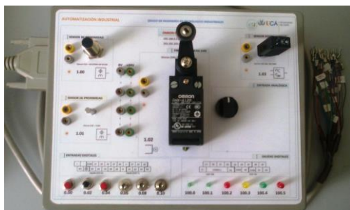
Figura 2. Maqueta de trabajo desarrollada para la realización de sesiones prácticas sobre sensórica industrial.
