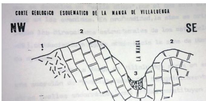
Figura 6. Corte geológico esquemático de La Manga de Villaluegan. Donde 1 son arcillas y yesos, 2 Calizas y 3 Margaocalizas.
