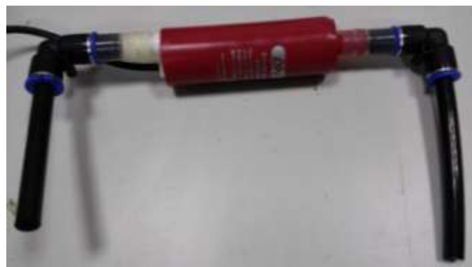
Figura 5: Muestra una de las bombas utilizadas para el sistema de agitación.
