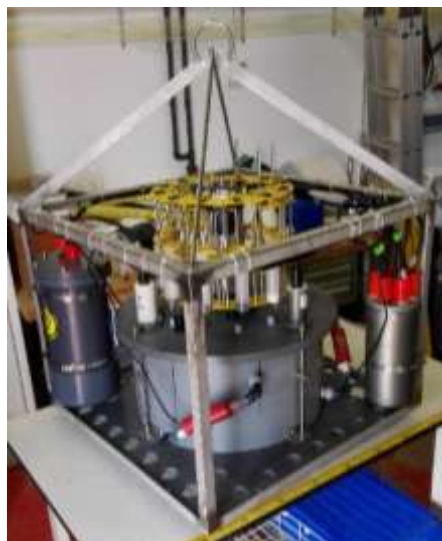
Figura 1: Cámara bentónica diseñada por el Departamento de Química-Física de la Universidad de Cádiz, para el estudio de sistemas costeros.
