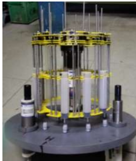
Figura 3: Muestreador provisto de doce jeringas de 50 ml que permitirá la toma de muestras del interior de la cámara durante el fondeo en los tiempos programados.
