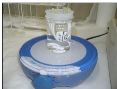
Imagen 3. Agitación de la muestra
