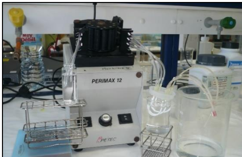
Imagen 2. Relleno de las fibras
