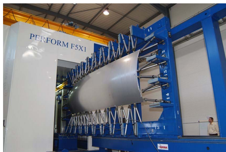
Figura 2.15 – Aluminium skin fuselage / Milling Mirror System. Solución desarrollada por Dufieux conjuntamente con Airbus para el fresado de pieles [88]
