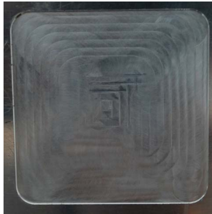
Figura 2.8 – Ejemplo de marcas de avance donde se contempla la trayectoria de la herramienta, entrada en el centro, trayectoria de dentro hacia fuera y salida en la esquina inferior derecha
