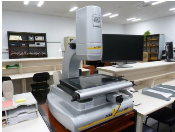
Figura 3.20 – Tesa Visio V300, equipo utilizado para medir los radios de acuerdo en las esquinas de las cajas
