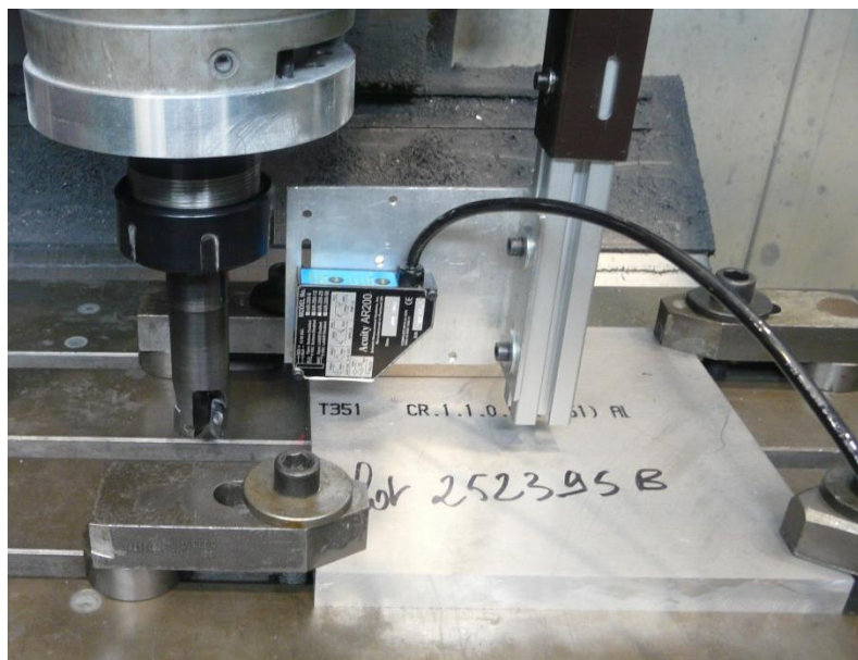
Figura 3.17 – Montaje para la medición por láser del espesor mecanizado con el láser por delante de la herramienta.
