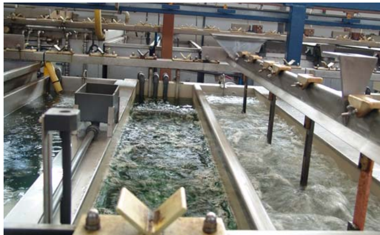
Figura 2.2 - Baños de limpieza de una línea de fresado químico
