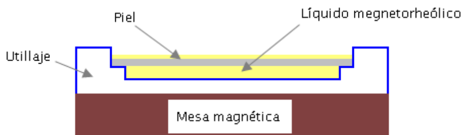
Figura 3.6 – Esquema de utillaje de amarre por líquidos magnetorreológicos
