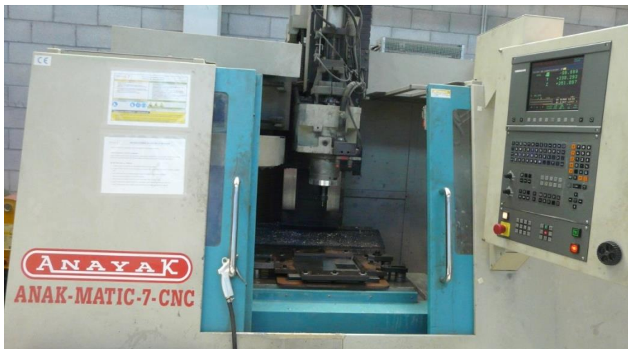
Figura 3.15 – Centro de mecanizado CNC de 3 ejes empleado para realizar los ensayos de medición de espesores mediante un sensor láser.
