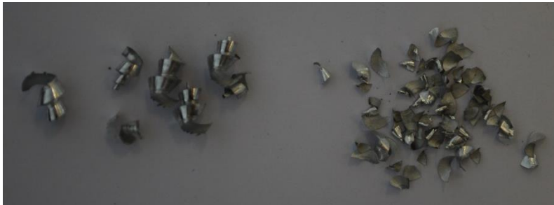
Figura 4.28 Virutas obtenidas en los ensayos realizados. Izquierda, ensayo D32 y derecha ensayo D10.
