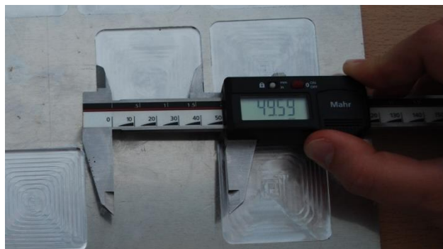
Figura 3.22 – Medida de las dimensiones de las cajas utilizando un pie de rey
